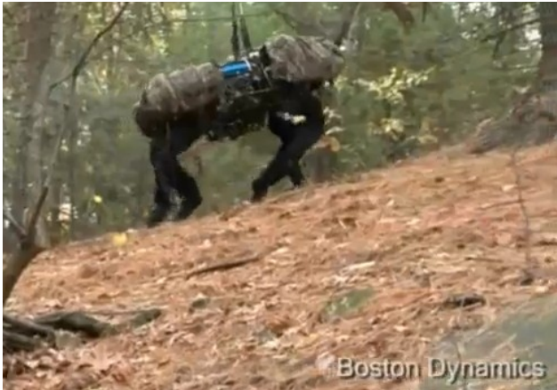
BigDog es un robot andador, cuadrúpedo, dinámicamente estable, para uso militar. Video: http://www.youtube.com/watch?v=cNZPRsrwumQ
